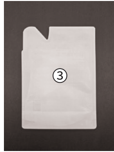
③ 막두께 130µm 재질(PE·PET)
